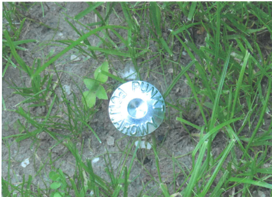
Fot. 6. Zastabilizowany punkt pomiarowy..
